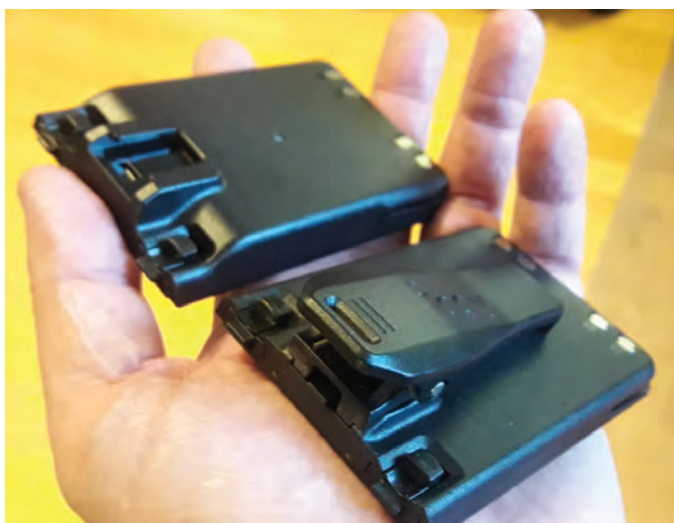
BILD 2: På radions baksida finner vi ett utbytbar laddbart batteri av samma storlek som Icom använder till sina handapparater, till höger ett batteri med fästsett bältesklip från handapparater.
