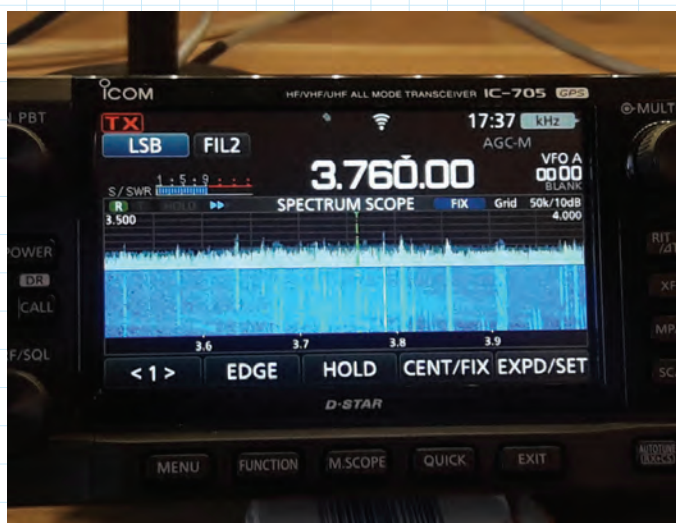
BILD 6: I en SDR-adio är vi vana vid spektrumvisning. En funktion som man inte vill vara utan då man väl vant sig. Den kan presenteras i lite olika format i IC-705.
