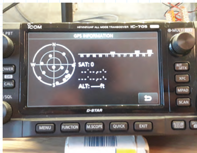
BILD 5: Inbyggd GPS i en amatörradio har man begränsad nytta av. Men då man kör D-star så används den för positionshantering.
