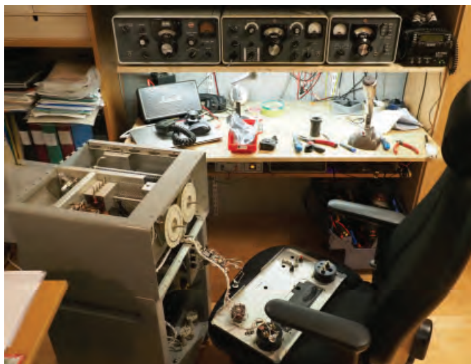
BILD 4: Som att lägga ett stort pussel. Det gäller att dokumentera väl så att alla bitar faller på plats. Fotografera, rita upp och kolla i schema och manualer så går det fint.
