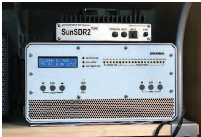
BILD 3: Här PA1000 framifrån med den relativt sett lilla radion SunSDR2 Pro från Expert Electronics ovanpå. Dess uteffekt om 15-20 W räcker mer än väl för att driva ut 1000 W från PA:t.
