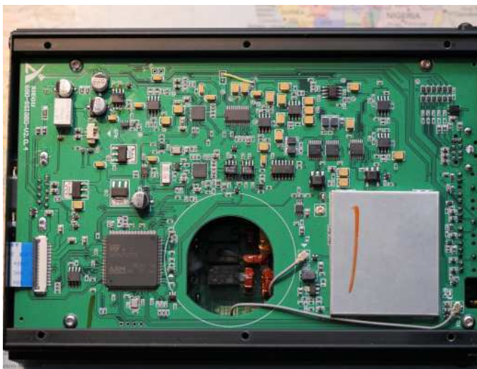
BILD 5. Digitaldelen av kortet har inte bara en stadig mikroprocessor och en del analog / digital-omvandlare. Under skärmplåten döljer sig mottagarens bandpassfilter, dämpsats och förstärkare.
