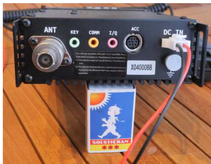
BILD 3. Riggen sedd bakifrån visar upp diverse kontakter. Antennkontakten av typen UHF/SO239 har i protest försetts med en adapter till BNC-kontakt.
