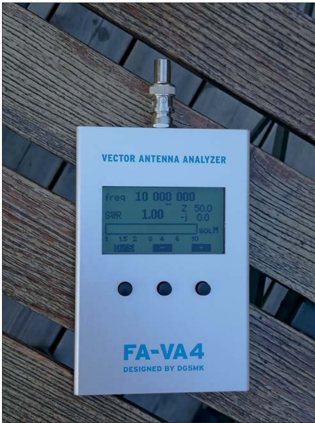
BILD 1: Ett litet smidigt instrument för antennmätning får man för blott EUR 150. Inbyggda batterier och tydlig display är toppen för fältbruk.
