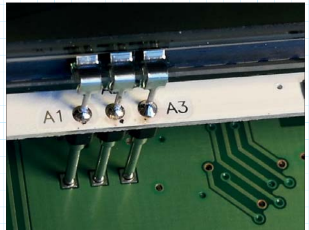
BILD 5: Även om det är stora komponenter som skall monteras så krävs en del handlag och en fin lödspets för att det skall fungera. Här detalj från lödning av bakgrundsbelysning till displayen.
