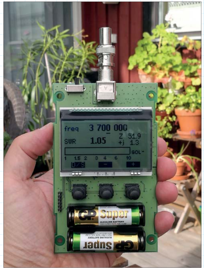
BILD 1: Ett litet smidigt instrument för antennmätning får man för blott EUR 150. Inbyggda batterier och tydlig display är toppen för fältbruk.
