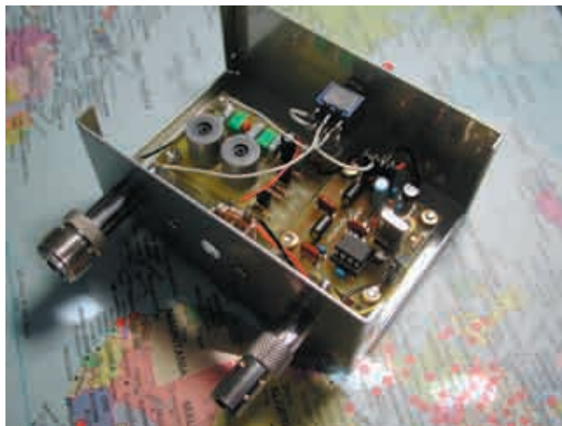
En liten låda för långa vågor. Till höger en konverter och till vänster en förstärkare och preselektoropton. Bygg denna och kom igång med lyssning på riktigt långa vågor.
