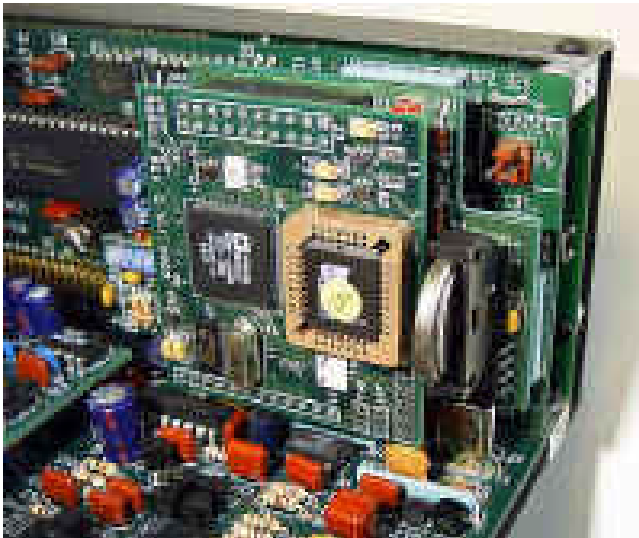
DSP-modulen sitter monterad på frontpanelens baksida i K2:an
