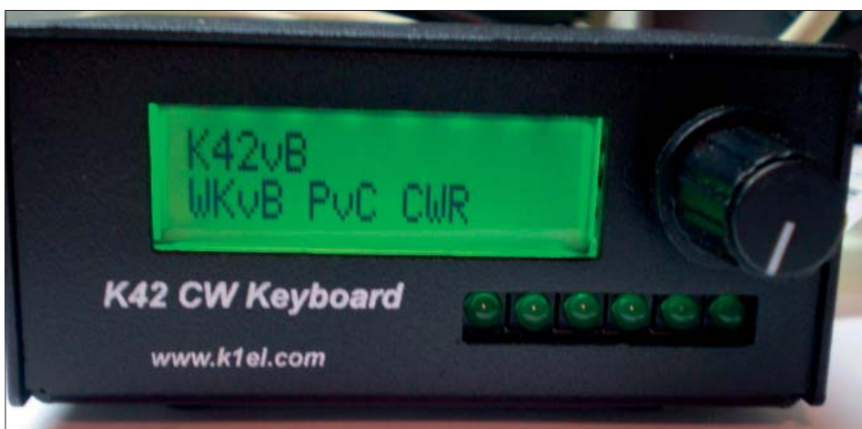
Det är inte bara vid dålig belysning som en LCD-visning blir mycket lättare att avläsa med bakgrundsbelysning. Här ser man hur tydligt texten kommer fram.
