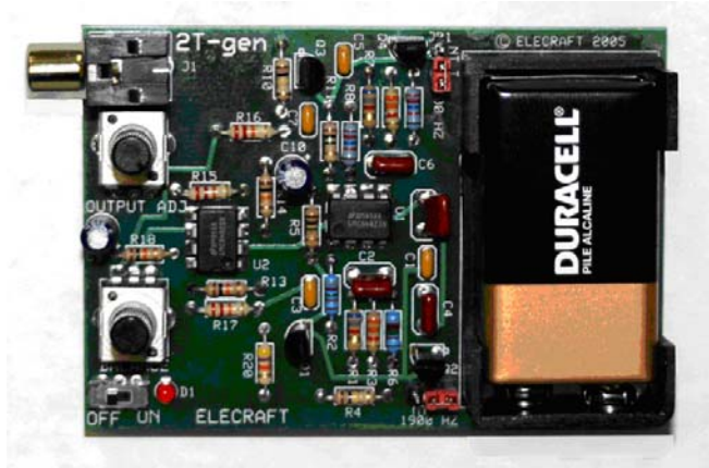
Tvåtonsgeneratoren från Elecraft ryms på ett litet kort och matas som synes från ett vanligt 9-voltsbatteri.
