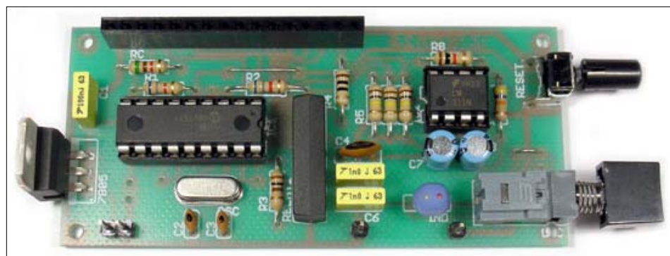
LC-mätaren; den stora kretsen är PIC16F84 som tar han om mätning och behandling av mätvärdena, för att sedan skicka dom till en LCD-display. Den lilla kretsen är en LM311 som skapar en känd frekvens. Enkelt sätt att mäta L och C med hög noggrannhet.
