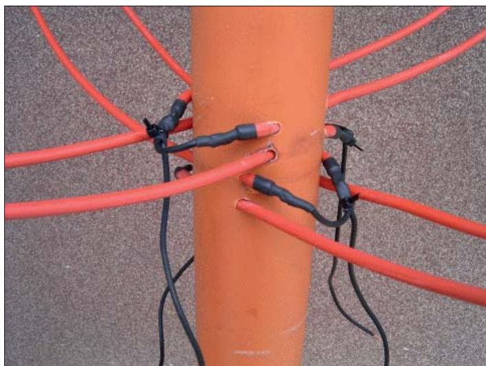
Bilden illustrerar ett elementalternativ med grov plastöverdragen koppartråd med två parallella loopelement vid inmatningspunkten mot förstärkarlådans masten i plast.
