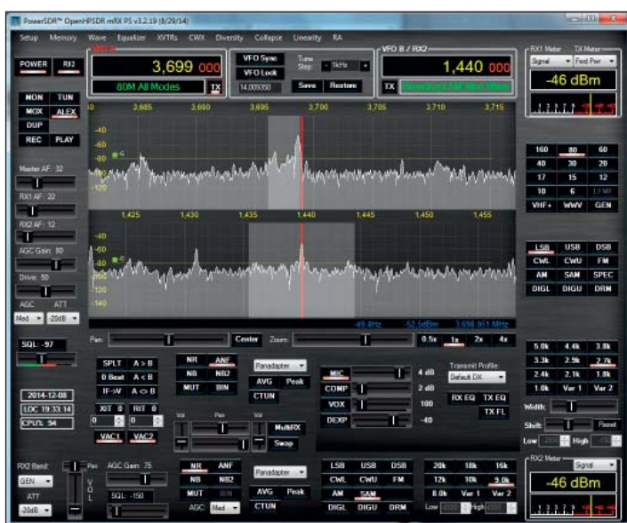
Fig 5: PowerSDR från OpenHPSDR för Windows är en gammal bekant (om än anpassad för HERMES och Apache-Labs). På bilden har vi kopplat in så att man kan köra två mottagare samtidigt. I detta fall lyssnar vi på 80 meter amatörband och mellanvågsrundradio samtidigt. Riktigt smidigt och fungerar ypperligt.
