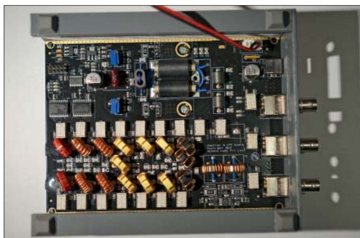
Fig 4: Längst ner i den gjutna aluminiumlådan finner vi PA-kortet med den omfattande låg och bandpassfilter. Designen kommer från Norge och LA2NI Kjell. Till höger i bild sticker antennkontaktarna av BNC-typ ut.
