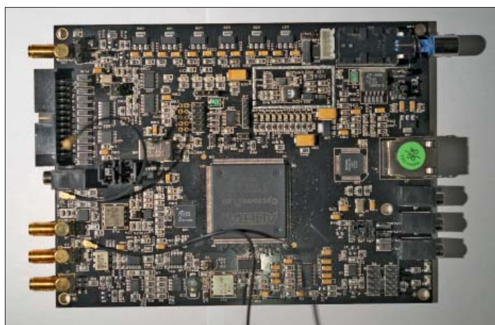
Fig 3: Under skalet ser vi bland annat HERMES-kortet. FPGA-kretsen tronar i mitten. på/av-knappen uppe till höger. Trångt om saligheten är det förstås gott om på detta högtintegrerade kort.
