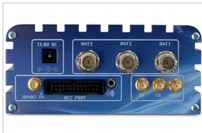
Fig 2: Så här ser radions baksida ut. Här dominerar 3 BNC-kontakter för att koppla in antenner. Nere till vänster kan man koppla in en extern 10 MHz referensoscillator för högsta frekvensnoggrannhet. Se artikeln för mera information.
