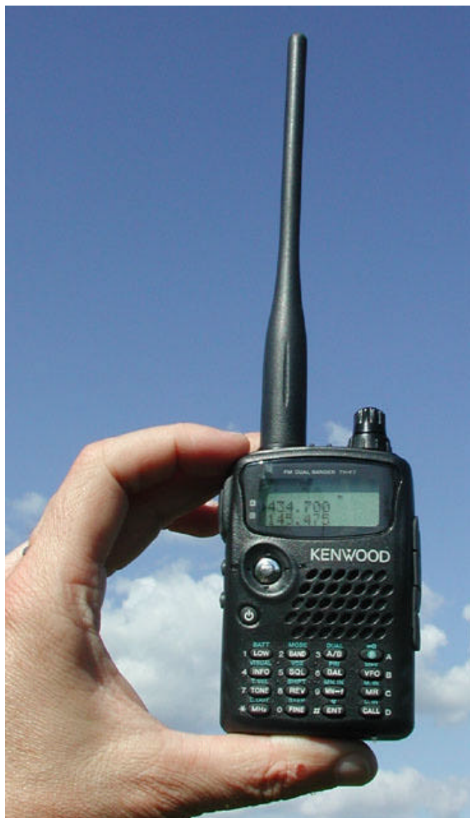
Inte bara 2 meter och 70cm hanterar denna lilla juvel. Även en bredbandsmottagare får plats i Kenwood TH-F7
