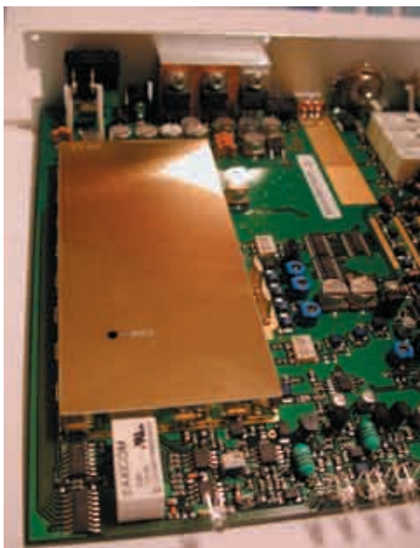
Innehållet är elegant utfört. Den stora lådan mellanfrekvensdelen för 455KHz
