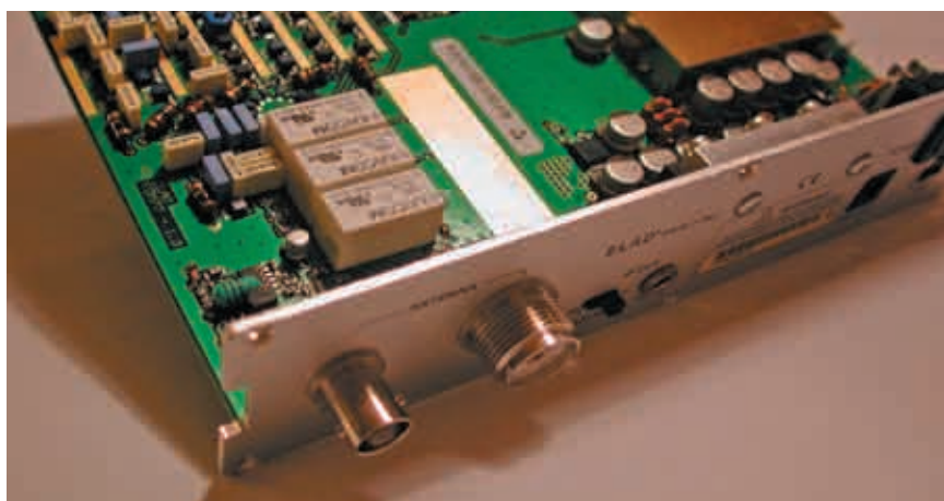
Baksidan har anslutning av antenn (BNC för liten och SO239 för stor), PC:ns ljudkort, spänningsmatning och USB för styrning
