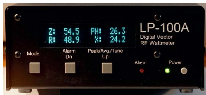
Fig 2: Fasvinklar (vektoranalys) av Impedans (Z), Reaktans (X) och Resistans.
