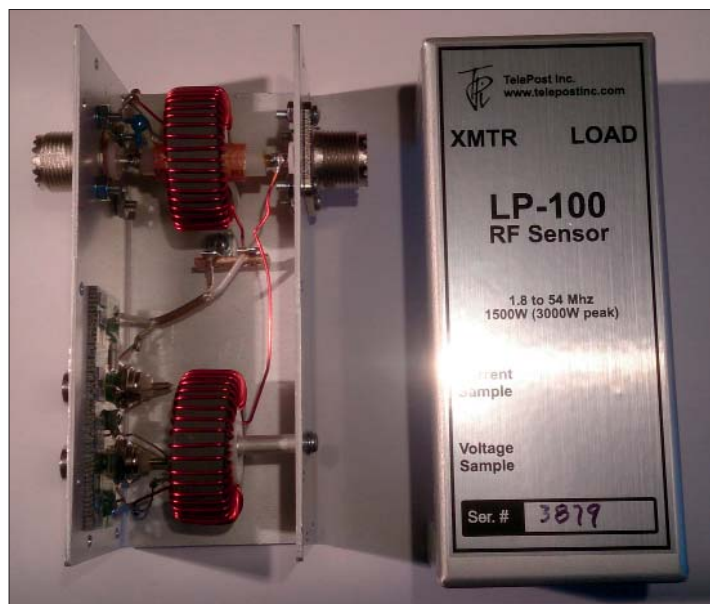
Fig 3: Så här ser proben ut om man lättar på locket. En helt vanlig mätbrygga med två induktanser (toroider) över signalledningar (koax). Utsignal (ström och spänning) till huvudenheten tas ut från sidan via vanliga koaxialkablar. Kabellängden får inte var för stor.
