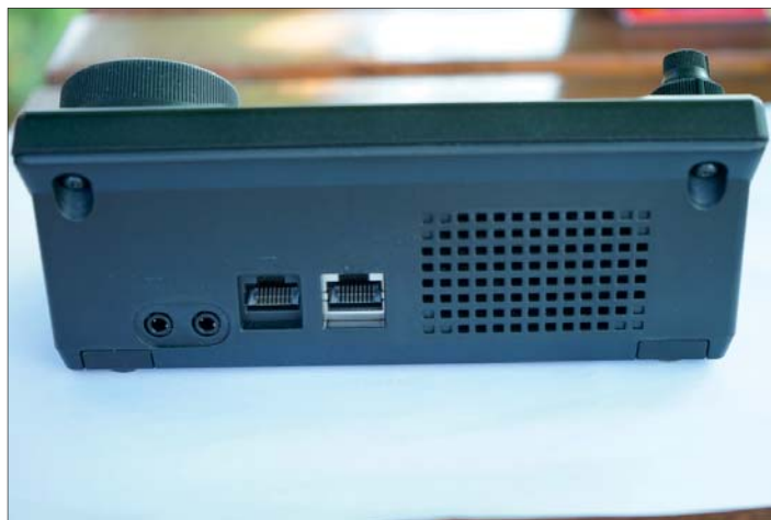
Figur 2: Vänder man på operatörspanelen återfinns några få kontakter för telegrafnyckel, extern högtalare, mikrofon och kabel för inkoppling mot radiodelen. Se till att inte koppla fel bara för rätt funktion.
