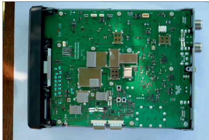
Figur 6 och 7: uppstädat och snygg som vanligt i en ICOM-radio. I huvudsakligen två kort på båda sidor om radions chassie/kylfläns.
