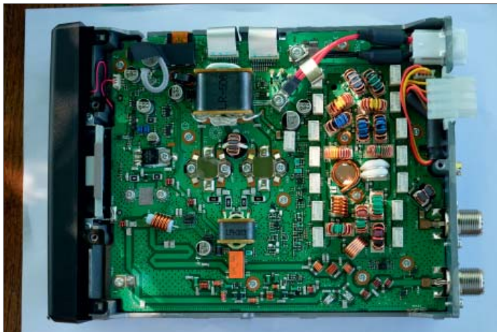
Figur 6 och 7: uppstädat och snygg som vanligt i en ICOM-radio. I huvudsakligen två kort på båda sidor om radions chassie/kylfläns.
