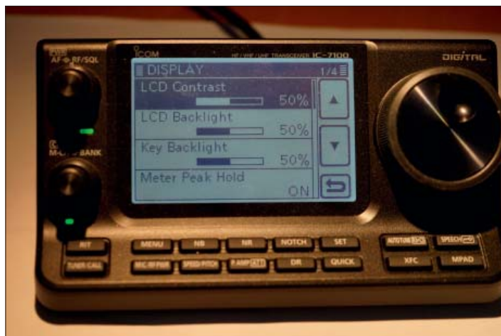
Figur 3 och 4: Menyerna och dess undermenyer är grafiskt presenterade och ger genom detta ett mera logisk och lättanvänt sätt än ofta kryptiska förkortningar i andra menysystem vi är vana vid. Det går att peka och "klicka" med fingret. Men att svepa och nypa som på smarta telefoner fungerar inte.
