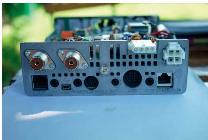
Figur 5: Tittar vi på baksidan av radiodelen ser vi en hel del bekanta kontakter för att ansluta oss till omvärlden. Notera den lilla USB-kontakten som används för att skapa kopplingar för virtuellt ljudkort och seriegränssnitt.
