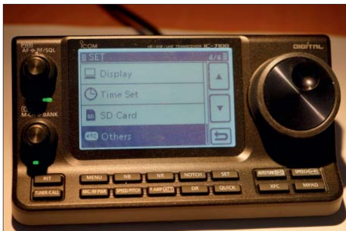
Figur 3 och 4: Menyerna och dess undermenyer är grafiskt presenterade och ger genom detta ett mera logisk och lättanvänt sätt än ofta kryptiska förkortningar i andra menysystem vi är vana vid. Det går att peka och "klicka" med fingret. Men att svepa och nypa som på smarta telefoner fungerar inte.
