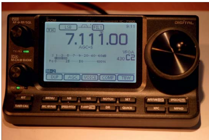
Figur 1: Det här är allt som behövs på operatörspanelen. Den lilla panelen som ser ut som en liten pulpet. Genom pekskärmen får man en ny och användbar dimension i användandet.
