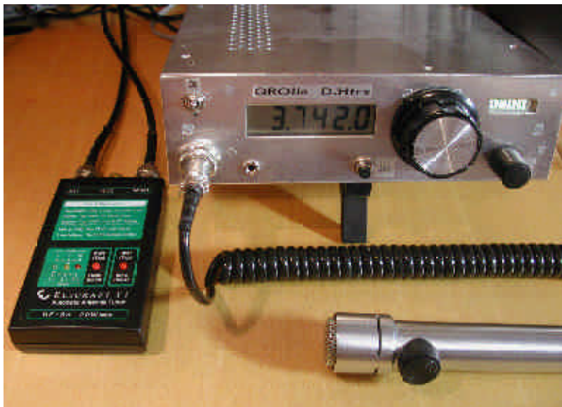
Den lilla fina automatturnern T1 från Elecraft har här anslutits till QROlle. Tunern spänningsmatas med ett inbyggt batteri. Alla kortvågsband från 160 m till 6 meter med en maximal effekt på ca 20 watt klaras av. Tunern kostar USD135 i byggsats.
