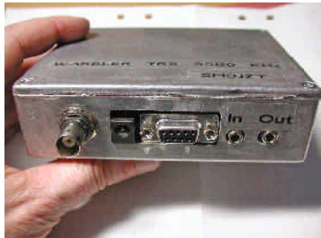
Det lilla kretskortet med den kompletta riggen WARBLER monterat i en lämplig låda. På sidan återfinns kontakter till: Antenn, spänningssmatning, PTT-styrning och LF-signaler till ett ljudkort.
