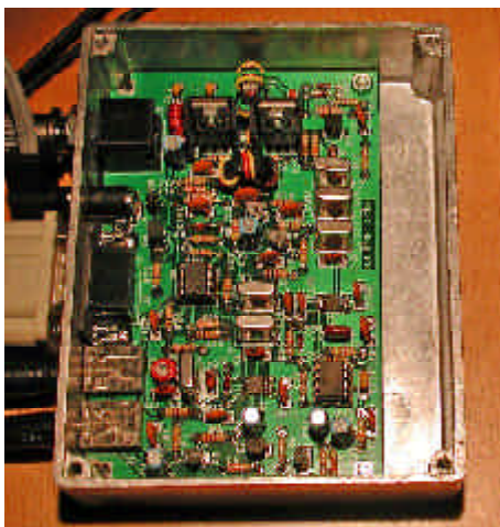
Det lilla kretskortet med den kompletta riggen WARBLER monterat i en lämplig låda. På sidan återfinns kontakter till: Antenn, spänningssmatning, PTT-styrning och LF-signaler till ett ljudkort.
