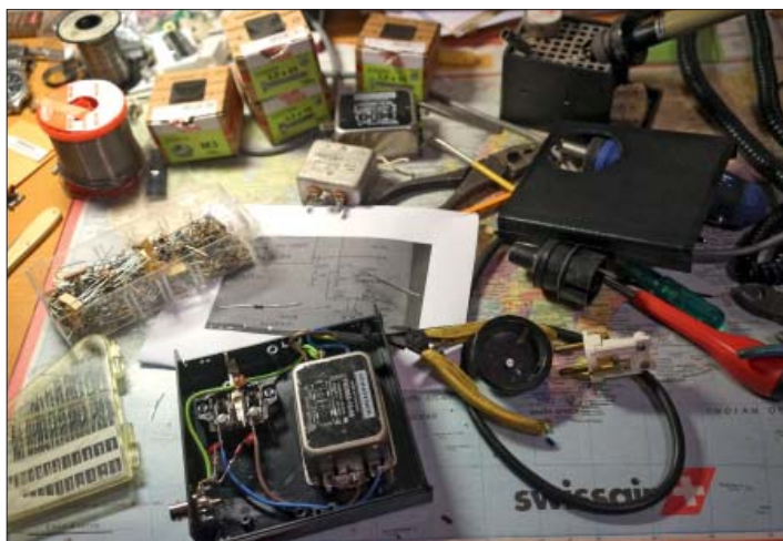
Fig 1. Så här såg det ut då AMN:en byggdes hos SMOJZT. Ur kaoset och lite grävande i junkboxen skapades en mätmojäng som hjälper att finna ondgörare bland annat LED-lampor av tveksam kvalitet.
