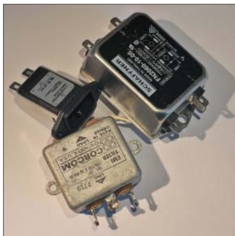
En liten handfull olika nätfiler. Varianten med integrerad nätbrunn är kanske mest platsbesparande. Tänk på eventuell avsäkring.
