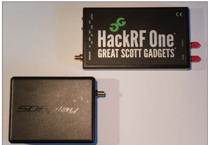
3: SDRPlay och Hack-RF är två av undertecknads favorit-SDR radios. Båda har sina för och nackdelar. Båda ansluts till PC:s via USB.
