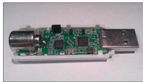
Figur 1 och 2. Exempel på DVB-pinnar. Den svarta från ebay och den vita från Kjell.com. Båda innehåller kretsen RTL2832. Den svarta innehåller tuner-kretsen R820T och den vita E4000.
