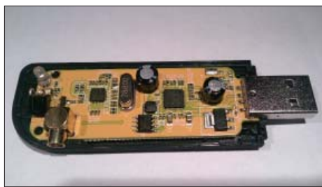
Figur 1 och 2. Exempel på DVB-pinnar. Den svarta från ebay och den vita från Kjell.com. Båda innehåller kretsen RTL2832. Den svarta innehåller tuner-kretsen R820T och den vita E4000.
