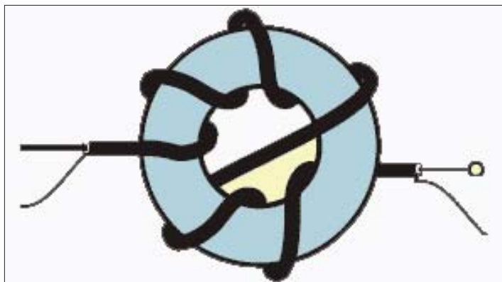
Bild 7 – Här ett principschema på en strömbalun/choke. Denna släpper inte förbi oönskade mantelströmmar till radion och monteras i serie med spänningsinjektorn. Byggs genom att linda koax enligt schemat på en toroid. Använd gärna den klenare RG174 och lida 5–8 varv på varje sida.
