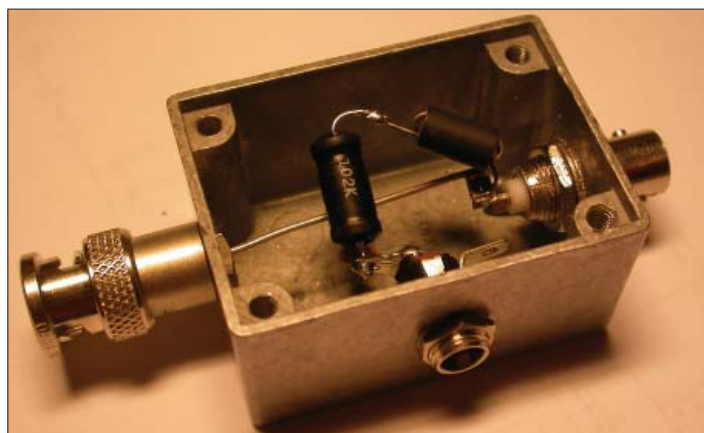
Bild 6 – Spännings (DC) injektor. Denna har lite annan komponentbestyckning än den i texten. Men principen är enkel, anslut DC till koaxen , mittedare genom en drossel (470 \mu H). Avkoppla koaxens mittedare mot radion via en konding (100 nF) så att DC kommer till försärkaren och inte in på radions ingång. Montera i lämplig låda med kontakter. BNC-kontakten till vänster i bild går till radion och koaxen till antennen kopplas till den högra.
