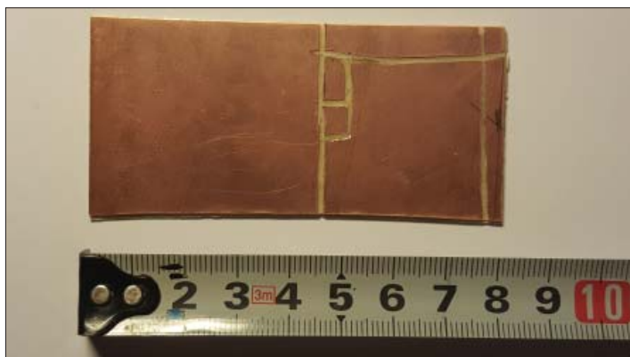
Bild 3 – En liten bit enkelsidigt glasfiberkretskortslaminat. En del fräsarbeten har gjorts för att skapa "löddöar".
