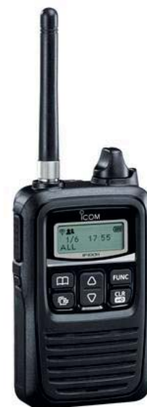
Fig 2, handapparaten IP100H ser ut som vilken handapparat som helst. Den fungerar i princip på samma sätt med PTT och så vidare. Skillnaden är att det här ju är en IP-telefon.
