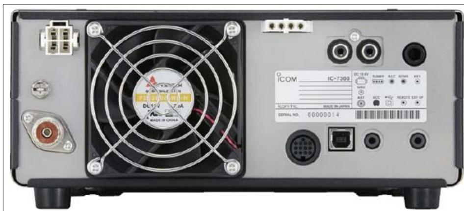
Bild 2: Tittar man på baksidan så känner man igen sig. Den till synes stora fläkten håller överskottsvärmen borta från 100 W-radion. USB-kontakten används för att interagera med en PC. Bäst hade varit som man använt en Ethernet-kontakt och TCP/IP för omvärldsgränssnittet.
