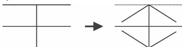
Själva grundtanken med antennen är att ha vikt reflektor och direktor, därmed kan man bygga den med sträckt tråd.
